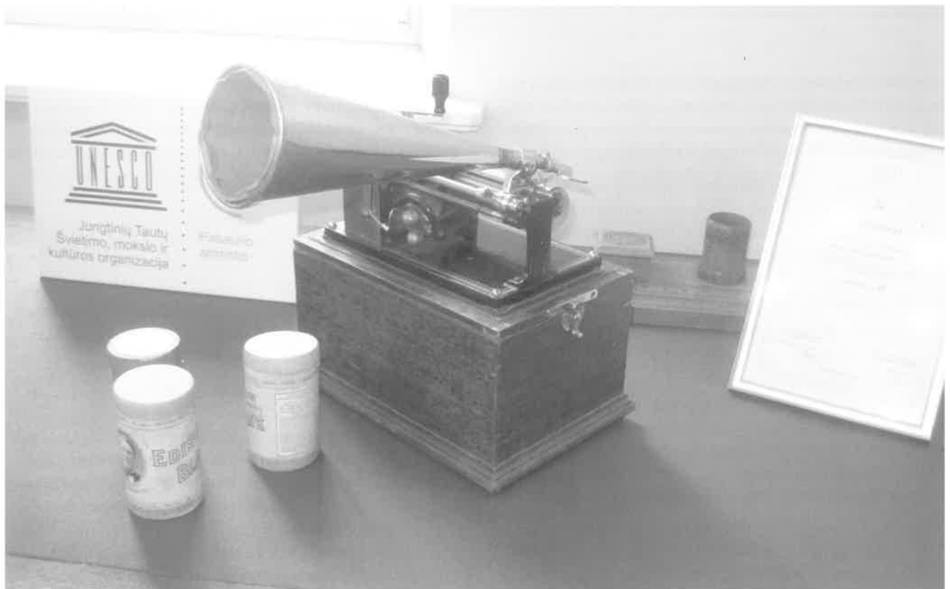
Garso įrašo įrenginys fonografas, įrašantis garsą ir atgaminantis jį vaškiniiais voleliais. LLTI institute saugomas dr. E. Volterio 1908–1909 m. įrašytų lietuvių liaudies dainų ir kt. kūrinių volelių rinkinys. 2013 m. spalio 17 d. Nuotr. V. Jocio
